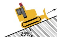
Rys. 2. Praca spycharek na pochyłościach podczas pracy pod górę
